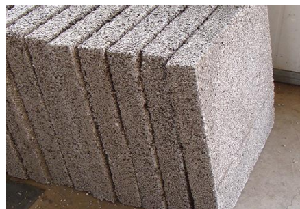
Ilustracja nr 5 Płyty polistyrenowe z betonu
