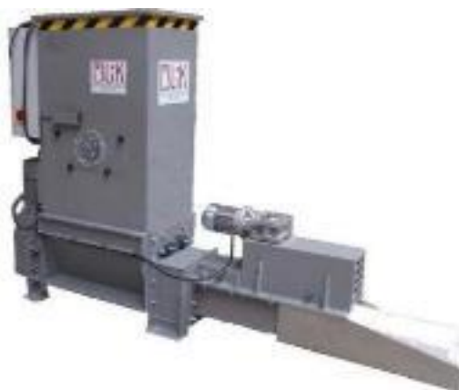
Compactador de poliestireno Blik POLY 2000 (Fonte: industry-plaza.com)
